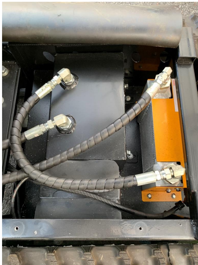
Nedre hydraulikkoljetank med radiator. Bilde fra en BY600
