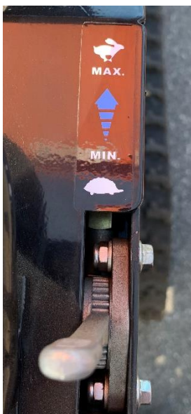
Figur 1: Spake til regulering av turtallshastighet til motoren
